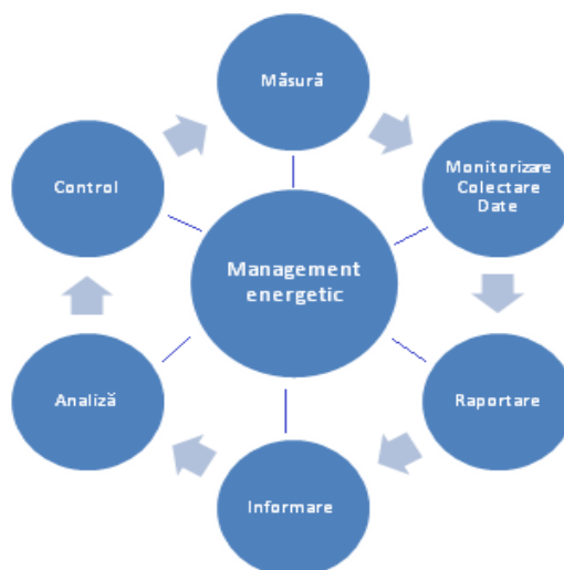
Figura 4.3.2.1 Componentele sistemului de management energetic
